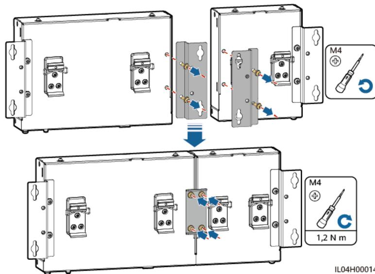
**Schritt 2** Montieren Sie den SmartLogger und das SmartModule.
