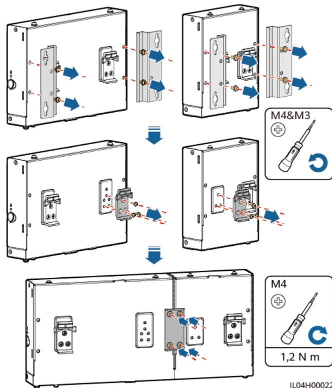
**Schritt 2** Montieren Sie den SmartLogger und das SmartModule.
