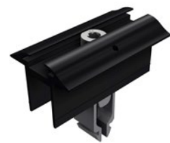
Mittelklemmen mit Erdungspin für Rahmenhöhe 28 mm - 45 mm
